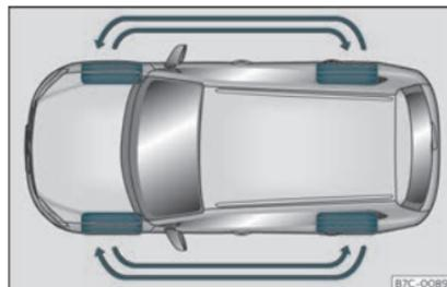
Fig. 195 Permutation des roues.
