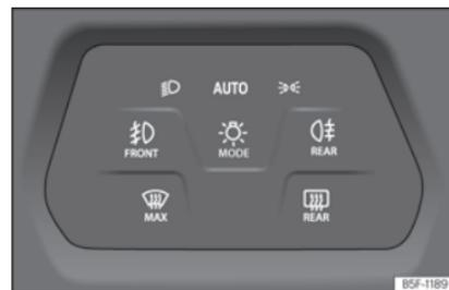
Fig. 85 Planche de bord : commande des feux.
