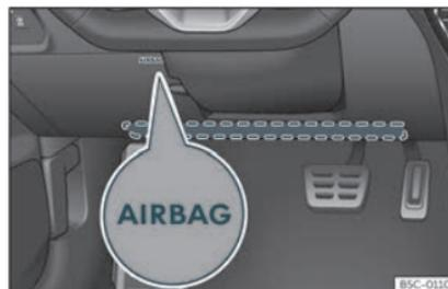
**Fig. 17** Côté conducteur : emplacement de l'airbag de genoux.
