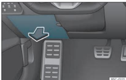
Fig. 47 Sur le combiné d'instruments côté conducteur : cache du boîtier de fusibles.
