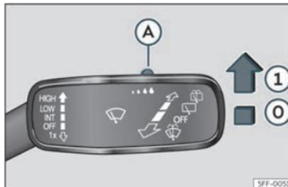
Fig. 91 Levier d'essuie-glace : régler le détecteur de pluie **A**
