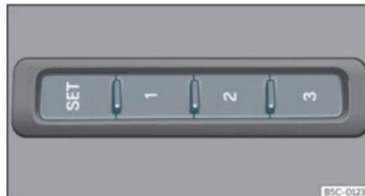
Fig. 100 Sur le côté extérieur du siège du conducteur : touches de mémorisation.
