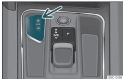
Fig. 66 Console centrale : Logement de la clé du véhicule.
