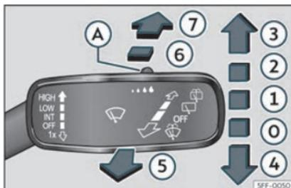
Fig. 90 Utilisation de l'essuie-glace avant et arrière.
