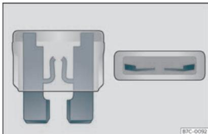
Fig. 49 Représentation d'un fusible grillé.
