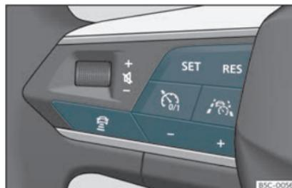
**Fig. 159** Partie gauche du volant multifonction : touches pour utiliser Travel Assist.
