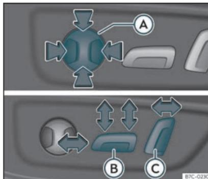
Fig. 96 Siège du conducteur : réglage électrique du siège.
