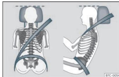
**Fig. 3** Sangle bien ajustée et appuie-tête correctement réglé.
