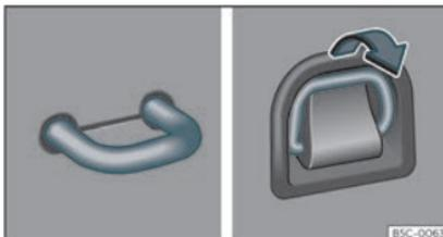
Fig. 111 Dans le coffre à bagages : œillets d'arrimage fixe et modulable.
