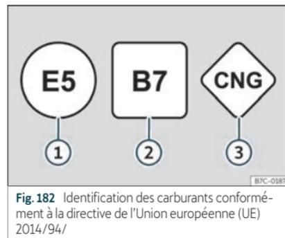
Fig. 182 Identification des carburants conformément à la directive de l'Union européenne (UE) 2014/94/
