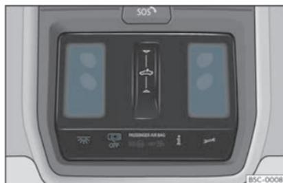
Fig. 88 Détail du ciel de pavillon : plafonnier avant.
