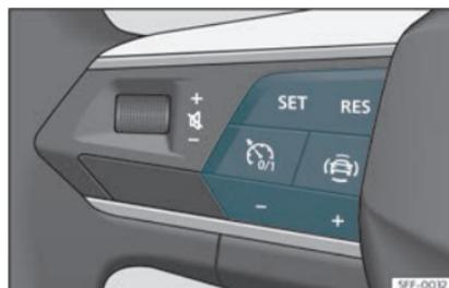
Fig. 147 Sur le volant multifonction : boutons permettant d'actionner le limiteur de vitesse
