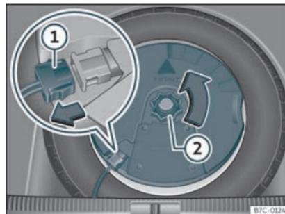
**Fig. 198** Dans le coffre à bagages : démonter le subwoofer.
