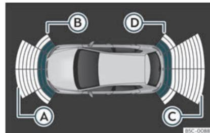
**Fig. 175** Affichage de l'aide au stationnement à l'écran du système d'infodivertissement.
