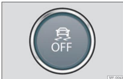
Fig. 169 Sur la partie inférieure de la console centrale : bouton d'activation/désactivation de l'ESC
