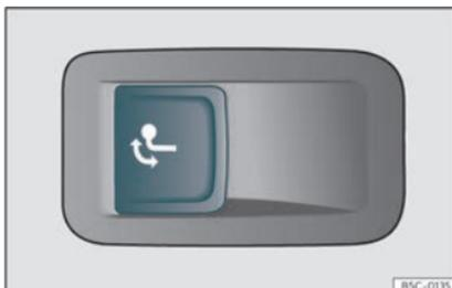
**Fig. 179** Sur le côté gauche du coffre à bagages : touche de déverrouillage du crochet d'attelage.
