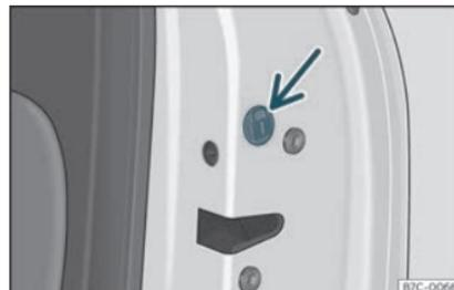
Fig. 75 Verrouillage d'urgence de la porte.
