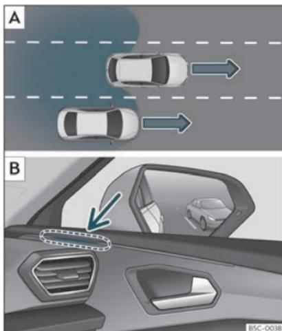
**Fig. 163** Représentation schématique : **[A]** Situation en cas de dépassement sur une voie centrale puis retour sur la voie de droite. **[B]** Indication de l'assistant de changement de voie sur le voyant de contrôle du côté droit.
