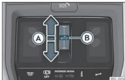
Fig. 83 Dans le ciel de pavillon : touche du toit ouvrant.
