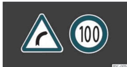
Fig. 53 Sur l'écran du tableau de bord : exemples de panneaux reconnus.
