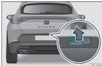
Fig. 77 Hayon : ouverture de l'extérieur.
