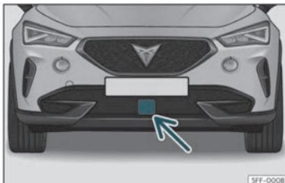
Fig. 140 Au niveau du pare-chocs avant : capteur radar.
