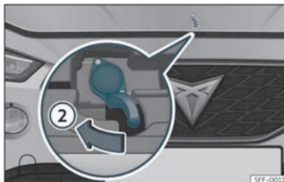
Fig. 184 Levier sous le capot.
