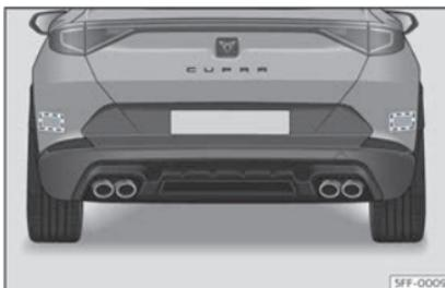
Fig. 143 Vue arrière du véhicule : zones des capteurs radars.
