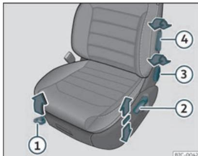
Fig. 95 Sièges avant : réglage manuel du siège.
