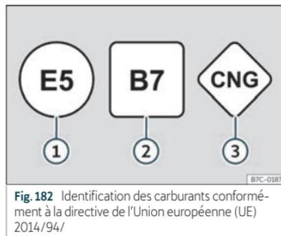
Fig. 182 Identification des carburants conformément à la directive de l'Union européenne (UE) 2014/94/
