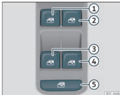
Fig. 82 Détail de la porte du conducteur : commandes des fenêtres.
