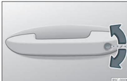
Fig. 74 Poignée de la porte du conducteur : barillet de fermeture.
