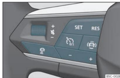
Fig. 151 Sur le volant multifonction : touches de manipulation de l'ACC
