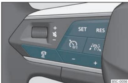
Fig. 159 Partie gauche du volant multifonction : touches de commande de Travel Assist.
