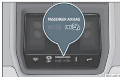
Fig. 16 Sur la console de pavillon : témoin de contrôle de la désactivation de l'airbag du passager avant.
