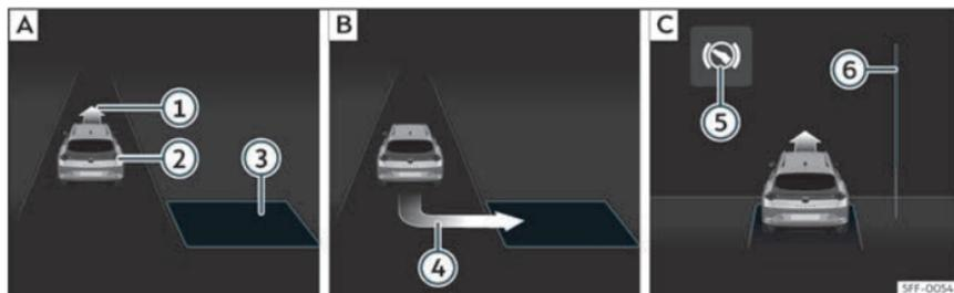
**Fig. 173** Sur l'écran du combiné d'instruments : stationner en bataille. **[A]** Chercher une place de stationnement. **[B]** Position de stationnement. **[C]** Manœuvrer.
