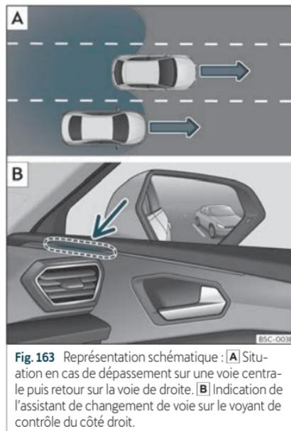
**Fig. 163** Représentation schématique : **A** Situation en cas de dépassement sur une voie centrale puis retour sur la voie de droite. **B** Indication de l'assistant de changement de voie sur le voyant de contrôle du côté droit.
