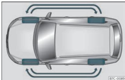
Fig. 195 Permutation des roues.
