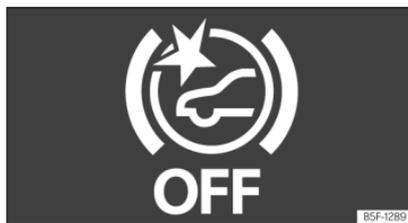
**Fig. 150** Sur l'écran du combiné d'instruments : indication de Front Assist désactivé.
