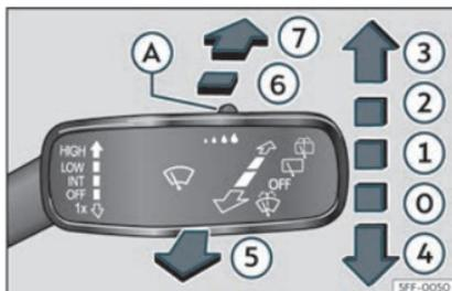
Fig. 90 Commande de l'essuie-glace avant et arrière.
