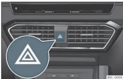
Fig. 87 Planche de bord : commande des feux de détresse.
