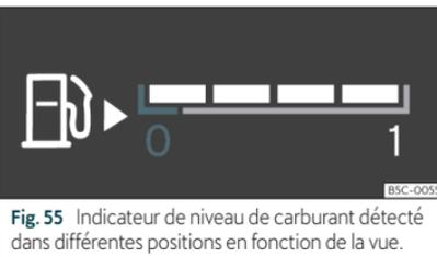
Fig. 55 Indicateur de niveau de carburant détecté dans différentes positions en fonction de la vue.
