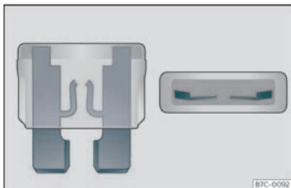
Fig. 49 Représentation d'un fusible grillé.
