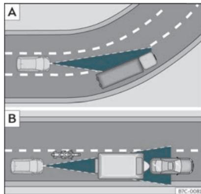
Fig. 154 A) Véhicule à l'abord d'un virage. B) Motocycliste circulant à l'avant hors du rayon d'action du capteur radar.
