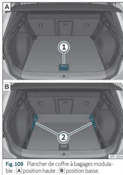
**Fig. 109** Plancher de coffre à bagages modulable : [A] position haute ; [B] position basse.
