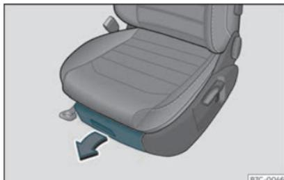
Fig. 119 Rangements sous les sièges avant.
