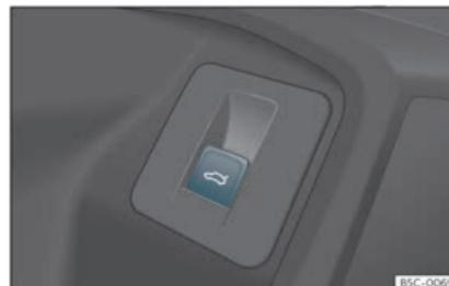
Fig. 79 Sur la porte du conducteur : touche d'ouverture et de fermeture du hayon arrière.
