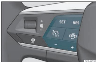
Fig. 146 Sur le volant multifonction : boutons permettant d'actionner le régulateur de vitesse
