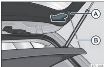
Fig. 105 Dans le coffre à bagages : dépose et repos de la plage arrière.
