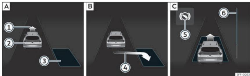
**Fig. 172** Sur l'écran du combiné d'instruments : stationner en créneau. **[A]** Chercher une place de stationnement. **[B]** Position de stationnement. **[C]** Manœuvrer.
