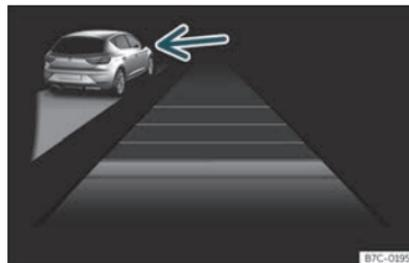
Fig. 153 Sur l'écran du combiné d'instruments : ACC actif, véhicule circulant à gauche détecté
