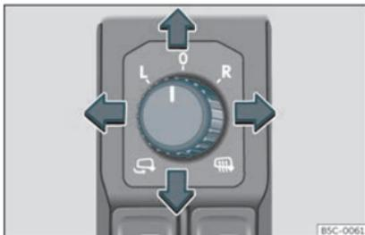
Fig. 93 Détail de la porte du conducteur : commande du rétroviseur extérieur.
