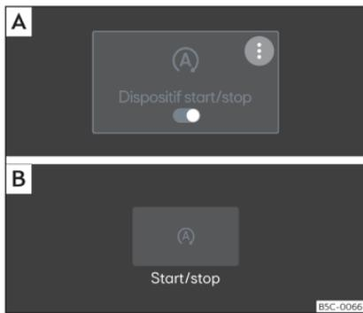
**Fig. 136** Sur l'écran du système d'infodivertissement : système Start-Stop activé. **A** Vue dans le menu principal. **B** Vue avec le système d'infodivertissement éteint.
