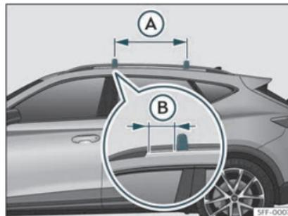
**Fig. 117** Points de fixation des barres longitudinales pour la galerie porte-bagages du toit.
