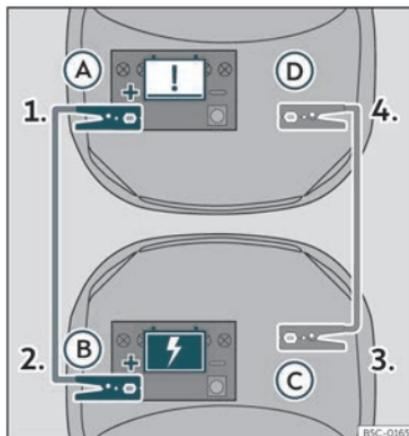
Fig. 42 Schéma de branchement pour les véhicules équipés du système Start-Stop.
