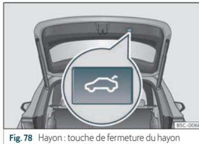
Fig. 78 Hayon : touche de fermeture du hayon
