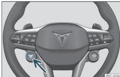
**Fig. 139** Volant multifonction\* : bouton servant à changer le profil de conduite.
