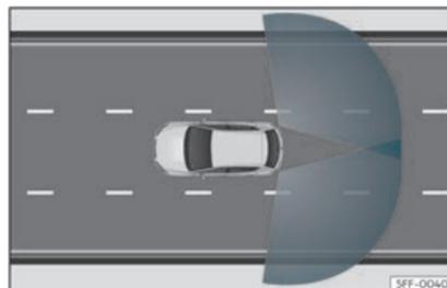
**Fig. 144** Zones de détection des capteurs
