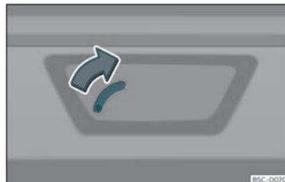
Fig. 81 Détail du coffre à bagages : déverrouillage d'urgence.
