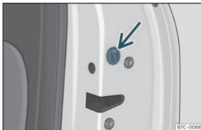
Fig. 75 Verrouillage d'urgence de la porte.
