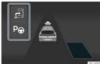
Fig. 170 Sur l'écran du combiné d'instruments : affichage du système de stationnement assisté avec affichage réduit.
