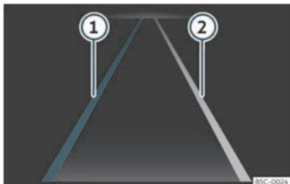
Fig. 156 Sur l'écran du combiné d'instruments : indications de l'assistant de maintien de voie.
