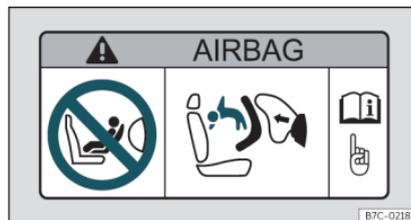
Fig. 25 Autocollant de l'airbag : sur le pare-soleil du côté passager avant
