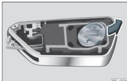
**Fig. 69** Clé du véhicule : retirez la pile.
