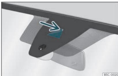
**Fig. 142** Sur le pare-brise : fenêtre de l'assistant de maintien de voie.
