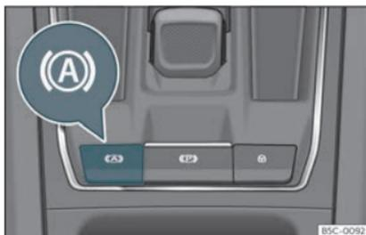
Fig. 168 Sur la partie inférieure de la console centrale : touche de fonction Auto Hold.
