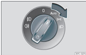
Fig. 92 Planche de bord : commande des feux.
