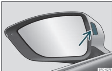
Fig. 170 Voyant de contrôle de l'assistant de changement de voie.
