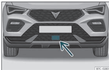
Fig. 148 Au niveau du pare-chocs avant : capteur radar.
