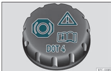
Fig. 206 Compartiment-moteur : bouchon du réservoir du liquide de frein.
