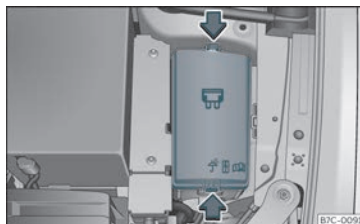
Fig. 47 Dans le compartiment-moteur : cache du boîtier de fusibles.
