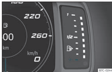
Fig. 60 Indicateur du niveau de carburant.
