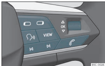
Fig. 62 Partie droite du volant multifonction : touches permettant d'utiliser les menus et les messages d'information du tableau de bord.
