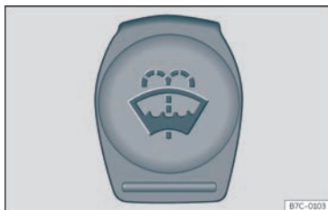
Fig. 207 Dans le compartiment-moteur : bouchon du réservoir de liquide lave-glace.
