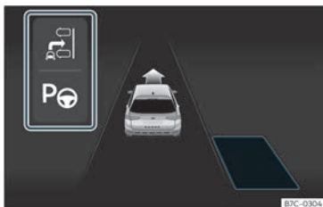
Fig. 178 Sur l'écran du tableau de bord : affichage du système de stationnement assisté avec affichage réduit.
