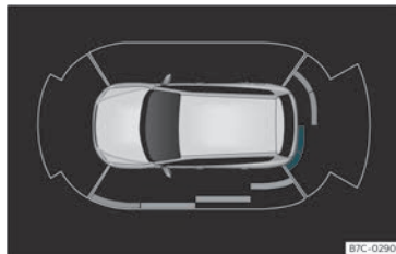
Fig. 185 Affichage de l'aide au stationnement à l'écran du système d'infodivertissement.
