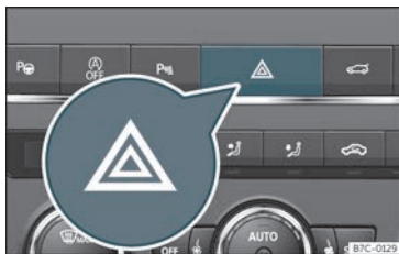
Fig. 95 Planche de bord : commande des feux de détresse.
