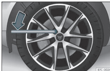
Fig. 34 Changement de roue : desserrer les vis de roue.
