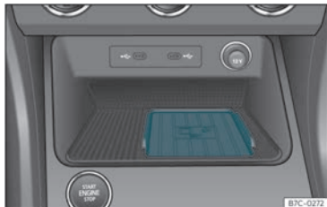
Fig. 136 Sur la console centrale : logement pour la connexion du téléphone mobile.
