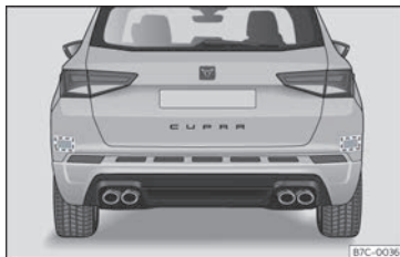
Fig. 151 Vue arrière du véhicule : zones des capteurs radars.
