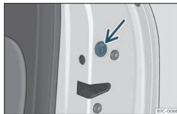
Fig. 80 Verrouillage d'urgence de la porte.
