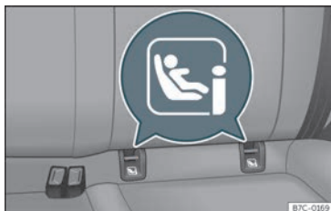
Fig. 25 Banquette arrière : anneaux de fixation ISOFIX/i-Size.
