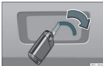
Fig. 87 Détail du coffre à bagages : déverrouillage d'urgence.
