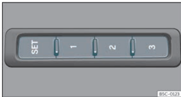
Fig. 106 Sur le côté extérieur du siège du conducteur : touches de mémorisation.
