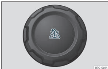
Fig. 205 Compartiment-moteur : bouchon du vase d'expansion du liquide de refroidissement.
