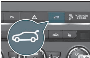
Fig. 84 Console centrale : touche d'ouverture et de fermeture du hayon arrière.
