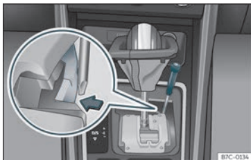
Fig. 145 Levier sélecteur : déverrouillage d'urgence de la position de parking.
