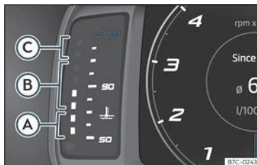
Fig. 61 Indicateur de température du liquide de refroidissement du moteur.
