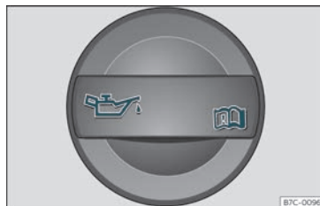
Fig. 203 Dans le compartiment-moteur : bouchon de l'orifice de remplissage d'huile moteur.
