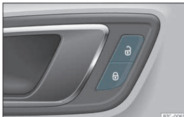
Fig. 75 Porte du conducteur : commande de verrouillage centralisé.
