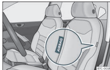
Fig. 19 Airbag latéral dans le siège du conducteur.
