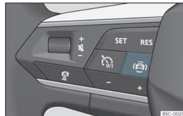
Fig. 64 Partie gauche du volant multifonction : touche pour les systèmes d'assistance à la conduite (en fonction des versions).
