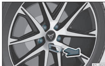
Fig. 32 Roue : boulons de roue avec capuchons.
