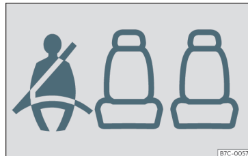
Fig. 5 Combiné d'instruments : indication de place arrière gauche occupée et de ceinture correspondante bouclée.
