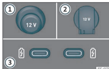
Fig. 127 Prises de courant de 12 volts du véhicule.
