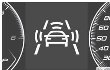
Fig. 158 Sur l'écran du tableau de bord : indications d'alerte préventive.
