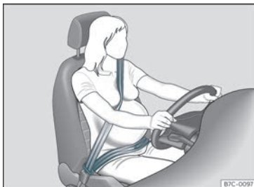
Fig. 12 Ajustement recommandé de la sangle de ceinture de sécurité pour les femmes enceintes.
