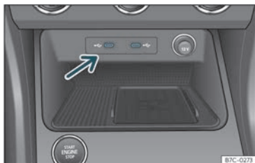
Fig. 137 Console centrale : entrée USB
