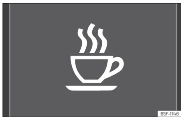
Fig. 58 Sur l'écran du tableau de bord : symbole de détection de la fatigue.
