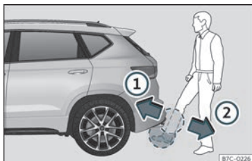
Fig. 85 Hayon du coffre à bagages à ouverture contrôlée par capteur (Easy Open).
