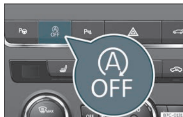
Fig. 141 Console centrale : touche du système Start-Stop.
