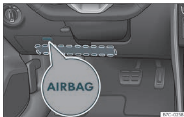
Fig. 17 Côté conducteur : emplacement de l'airbag de genoux.
