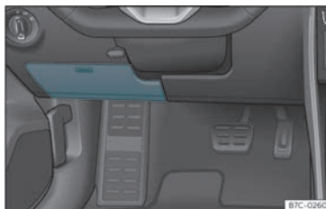
Fig. 45 Véhicules avec volant à gauche : couvercle de boîte à fusibles sous le tableau de bord, côté conducteur
