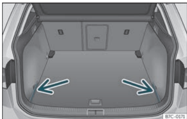
Fig. 112 Dans le coffre à bagages : caches de rangement de la plage arrière.
