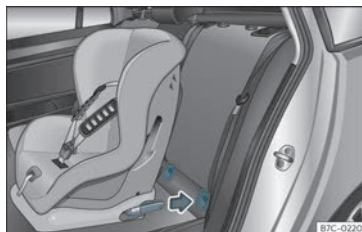
Fig. 26 Banquettes arrière : emplacement des sièges pour enfants avec le système ISOFIX.
