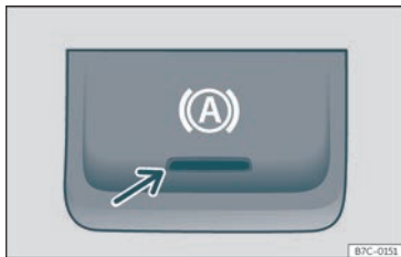
Fig. 176 Sur la partie inférieure de la console centrale : touche de fonction Auto Hold.
