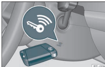
Fig. 140 À droite de la colonne de direction : démarrage d'urgence.
