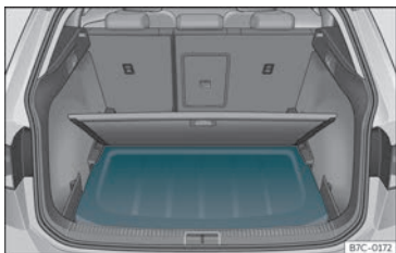
Fig. 113 Dans le coffre à bagages : placement de la plage arrière.
